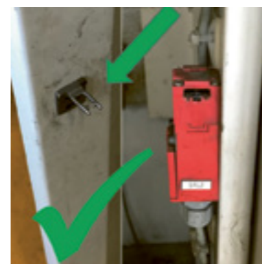
Megfelelő reteszrendszer, ahol a gép ajtajának nyitásakor leáll a berendezés
