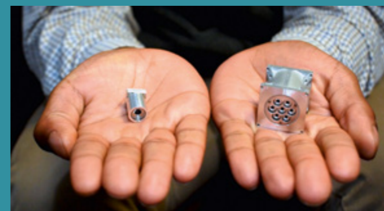
Megdöbbenően kicsi: a Morpheus Space műholdakhoz gyártott ionsugár-hajtóművek
