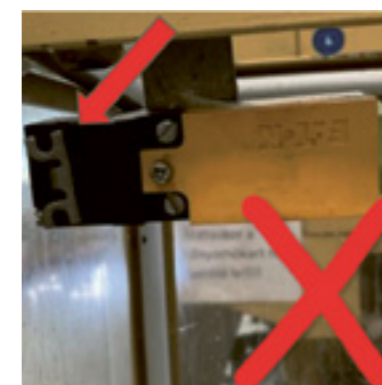
Kiiktatott reteszkapcsoló, ahol a berendezés nem áll le a gépjárat nyitásakor
